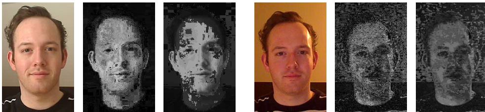
Abb. 12: Skin probability maps , die unter Verwendung eines quantisierten und nicht-quantisierten Farbmodells ( s = \frac{1}{4} ) erzeugt wurden. Jeweils links das Farbbild, daneben die skin probability maps unter Verwendung eines unquantisierten Farbmodells (jeweils in der Mitte) und einem quantisierten Farbmodell (jeweils rechts).
